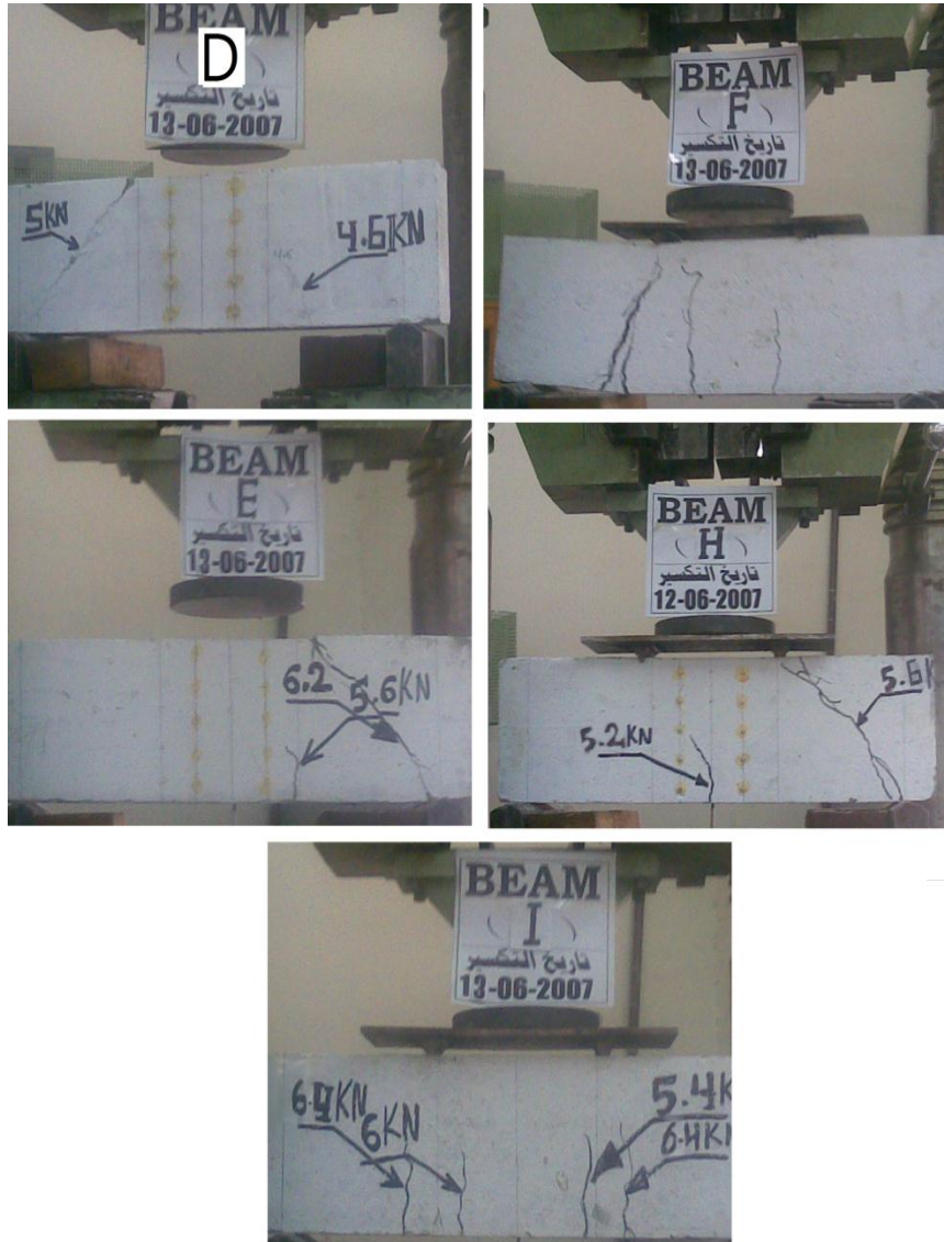
شكل (6) يوضح انهيار الكمرات الخرسانية المسلحة
